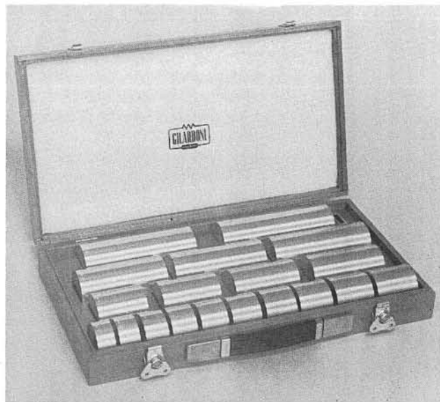
Fig. 19 - Serie di blocchi campione DISTANZA-AMPIEZZA (ASTM). Serie di 19 blocchetti aventi diametro dei fori fisso pari a 3/64" (1,2 mm) o 5/64" (2 mm) o 8/64" (3,2 mm) e profondità del foro variabile (vedi tab. II). Indicata per tracciatura dei diagrammi ADA (o DGS) e della curva DAC direttamente sullo schermo.
