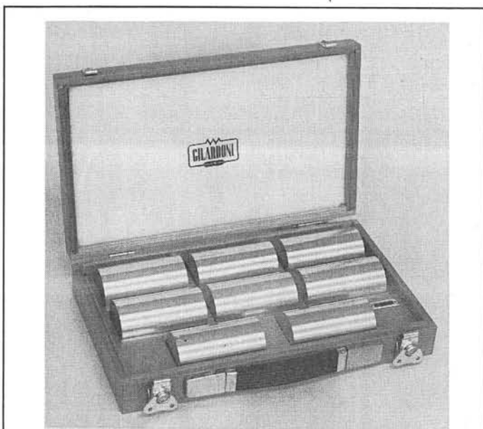
Fig. 18 - Serie blocchi campione AREA-AMPIEZZA (ASTM). Serie di 8 blocchetti aventi percorso fisso e pari a 3" (76,2 mm) con diametro dei fori variabile da 1/64" (vedere tab. I). Utile in particolare per valutare la linearità di amplificazione degli apparecchi a ultrasuoni.
