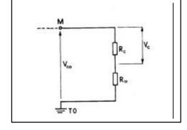
Si può osservare che risulta sempre  $V_C < V_{C0}$  tuttavia, se  $R_{TP} >> R_C$  (scarpe e pavimento isolanti e asciutti), risulta  $V_C << V_{C0}$  mentre se  $R_{TP} << R_C$  (scarpe e pavimento non isolanti, umidi o bagnati) risulta  $V_C \approx V_{C0}$ .
